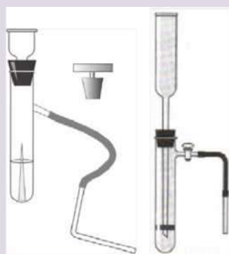
Рис. 7. Прибор для получения и собирания газов
