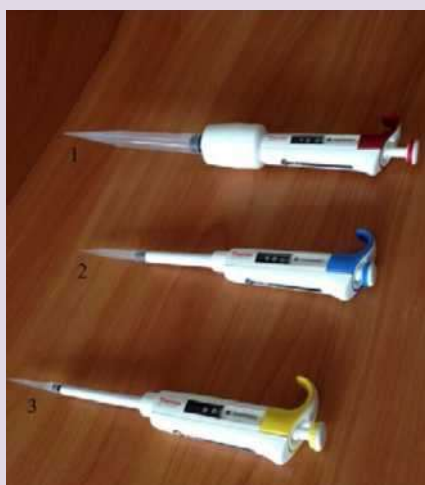
Рис. 5. Пипетки дозаторы одноканальные переменного объёма: 1 — 110 мл; 2 — 100—1000 мкл; 3 — 10—100
