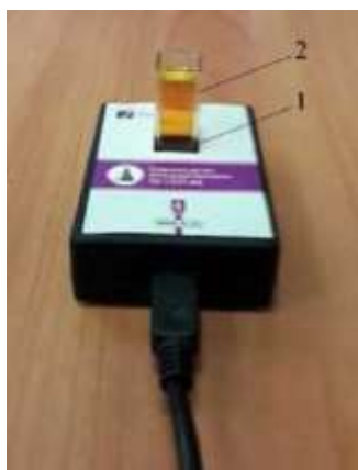
Рис. 1. Датчик оптической плотности: 1 — гнездо для кюветы; 2 —
